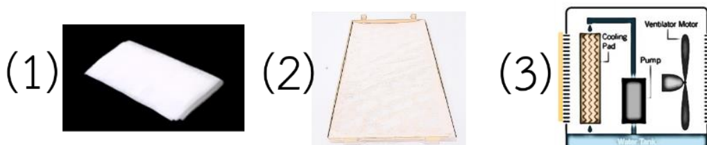
ภาพที่ 1 ขั้นตอนการสร้าง เครื่องดักจับ PM2.5 จากพัดลมไอเย็นและแผ่นกรองอากาศ HEPA
