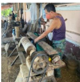
ภาพที่ 1 การใช้งานเครื่องกลึงไม้ก่อนการติดตั้ง
